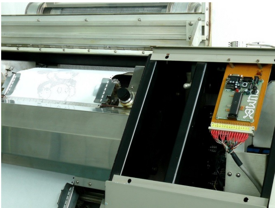
Abbildung 6: Gut sichtbares Breakout-Board zu Demonstrationszwecken direkt am Drucker befestigt. Hier können wir ASCII-Art usw. ausdrucken.
